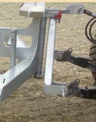
Das Drehgelenk ermöglicht eine optimale Kurvenarbeit. Somit können Hindernisse problemlos umgefahren werden. Die Tretschicht wird nicht mehr in die Ecken verschoben. Die automatische Arretierung fixiert den Steel Master beim Hochheben mit der Traktorhydraulik.
