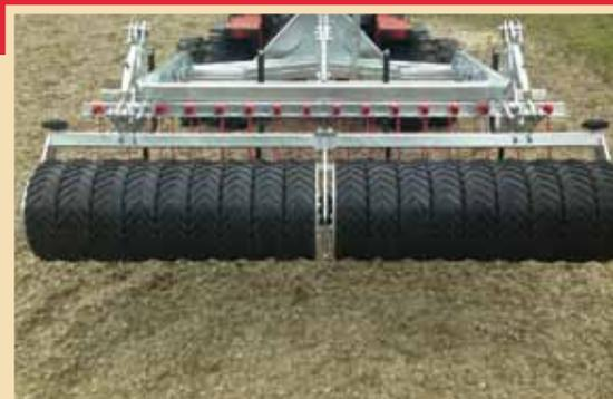
Die profilierte Gummiwalze oder die schuppenförmige Gitternetzwalze glätten und stabilisieren den aufgelockerten Boden.
